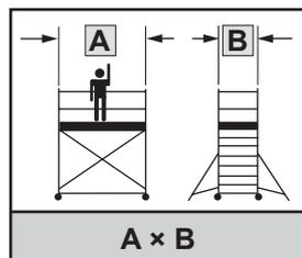
Longitud de la plataforma × anchura del bastidor
