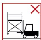
El producto no debe ser levantado con medios mecánicos o eléctricos.
