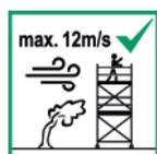
No se debe utilizar ni montar si la intensidad del viento supera los 12 m/s (6 Beaufort).
