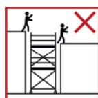
El producto no debe utilizarse como base para trepar por otras superficies (por ejemplo, cajas de escaleras, edificios, etc.).
