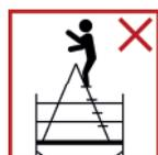
La plataforma no debe utilizarse como base para otros medios de escalada o para realizar cualquier trabajo que supere la altura máxima especificada.
