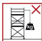
No se permite la fijación y el uso de polipastos, montacargas o equipos similares.
