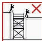
El producto no debe utilizarse como base para trepar por otras superficies (por ejemplo, cajas de escaleras, edificios, etc.).
