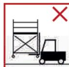
El producto no debe ser levantado con medios mecánicos o eléctricos.
